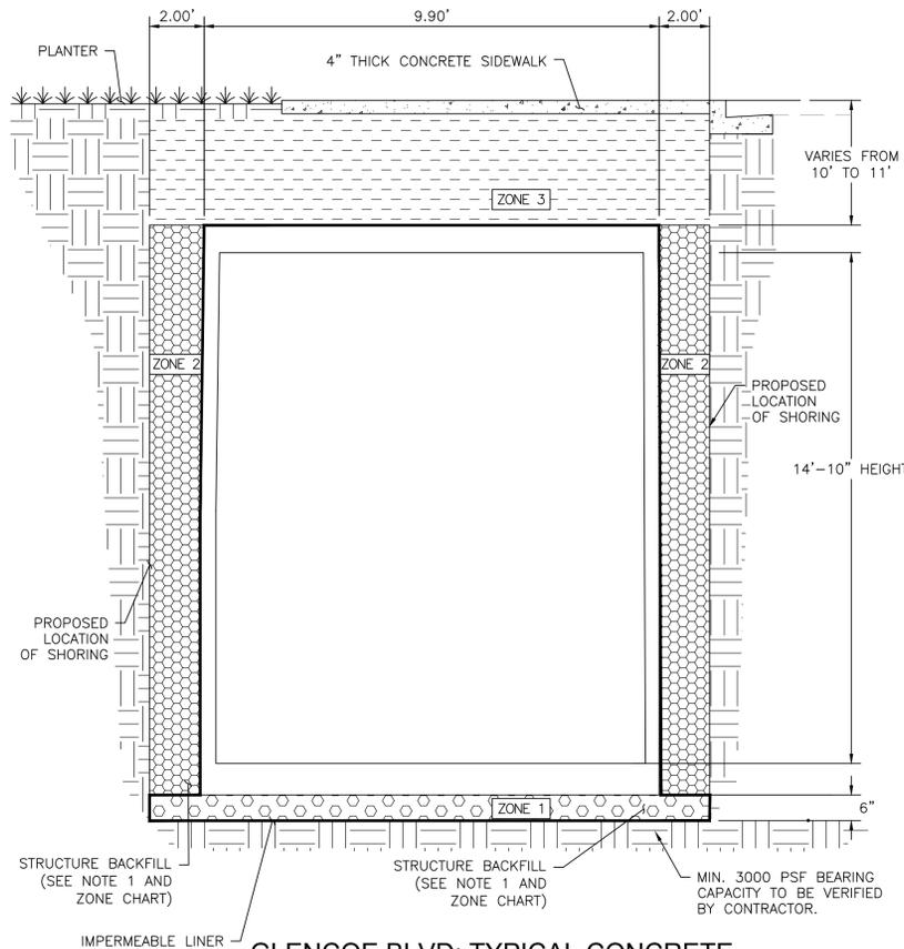
**GLENCOE BLVD: TYPICAL CONCRETE SUBSURFACE STORAGE TANK SECTION**
